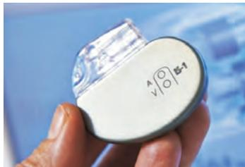
An ihm sind ein oder zwei lange, sehr dünne elektrisch isolierte Leitungen angeschlossen, die sogenannten Elektroden. Dies sind die Verbindungen zwischen Herzschrittmacher und Herz.
